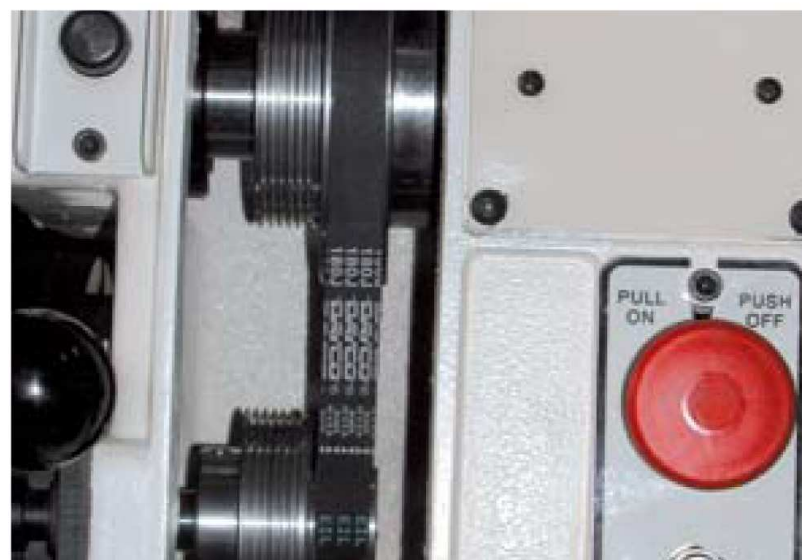
Zwei Riemenstufen für hohes Drehmoment beim Dreheln grosser Durchmesser
